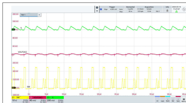
图 7-8. DCM Steady State Ripple
