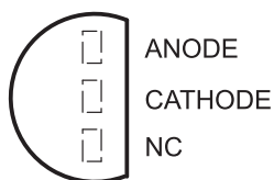
LM285-1.2, LM385-1.2, LM385B-1.2 . . . LP PACKAGE (TOP VIEW)
