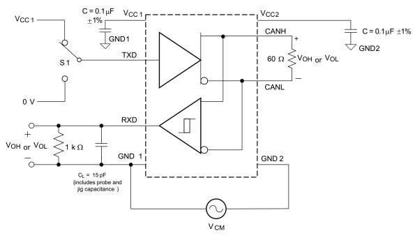
图 24. Common-Mode Transient Immunity Test Circuit
