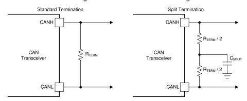
图 31. CAN Bus Termination Concepts
