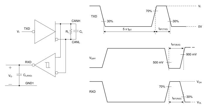
图 21. CAN FD Timing Parameter Measurement
