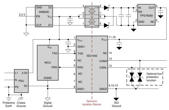
图 28. Application Circuit With ISO1042 in 16-SOIC Package
