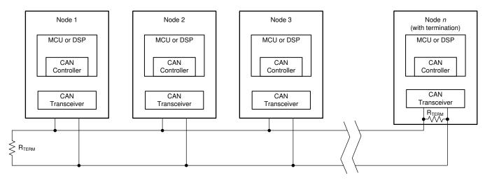
图 30. Typical CAN Bus
