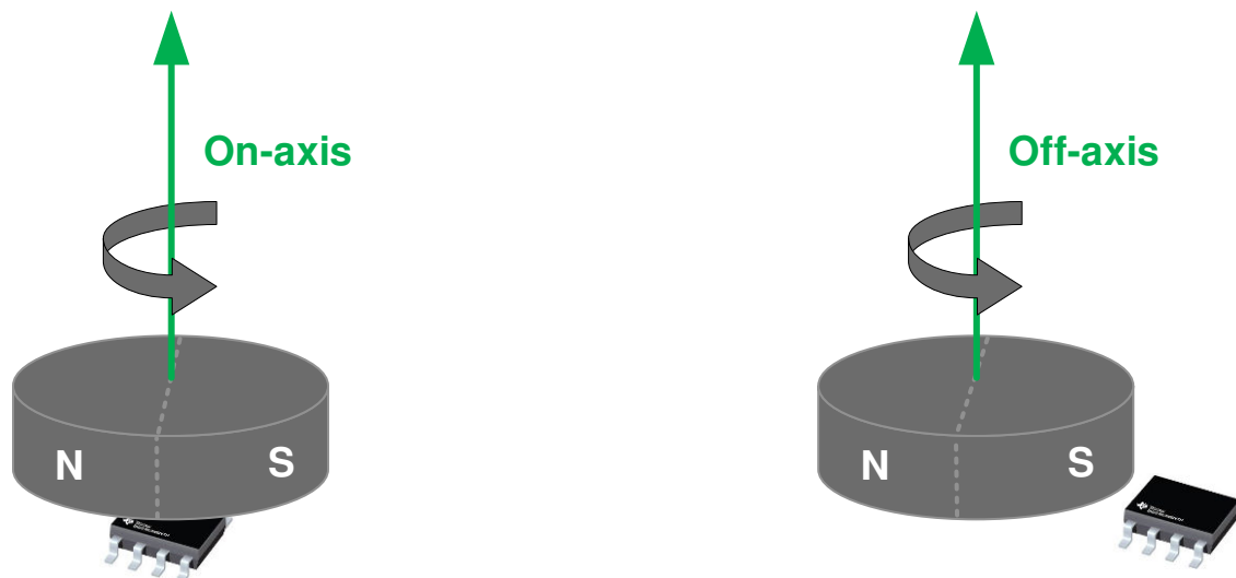
图 8-5. 同轴角度测量与离轴角度测量
