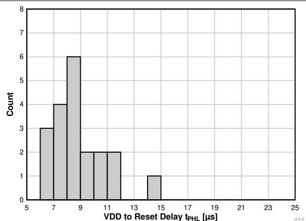
图 6-16. TPS3823A-33 器件在 25°C 时的 VDD 至复位延时直方图 (单位数 = 20)
