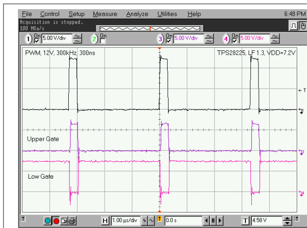
图 6-4. 12-V PWM Pulse at V_{DD} = 7.2\text{ V}
