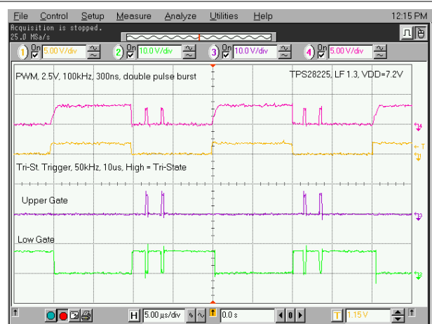
图 6-3. 2.5-V Amplitude PWM Pulse
