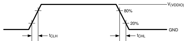
图 4-1. LVCMOS Transition Times
