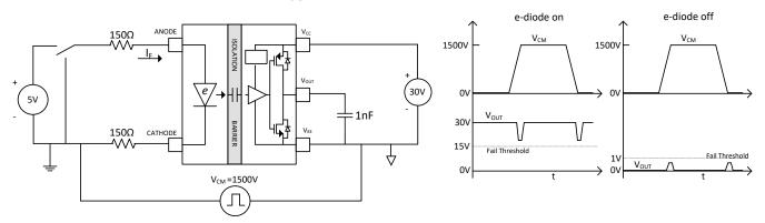
图 7-3. CMTI Test Circuit
